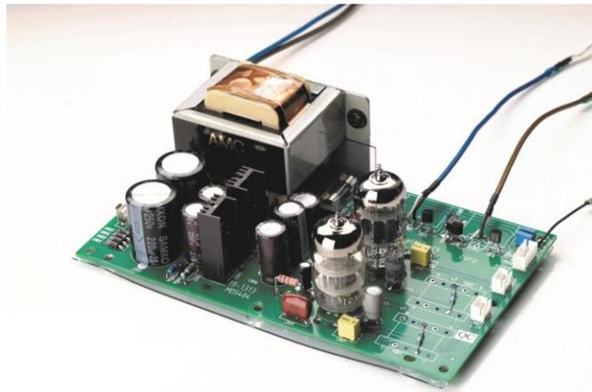
Zwei **12AU7** Doppeltrioden arbeiten, kanalgetrennt, im reinen **Class A** Betrieb, in den **Ausgangsstufen**. Die Röhren sitzen in Röhrensockel (auf der anderen Platinenseite) und sind somit einfach zu tauschen. Im Ergebnis wird dem/der Hörer/in ein **audiophiles Klangerlebnis** geboten.
