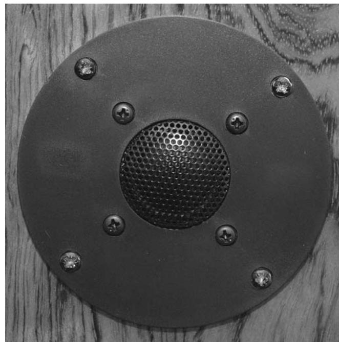
dass es am unteren- und/oder oberen- Frequenzbandende zu Einschränkungen käme, wäre der Filante 21 ein nahezu idealer Lautsprecher. Das untere Frequenzbandende kann der Breitbänder aufgrund seiner Größe sehr gut abbilden. Beim oberen unterstützt ihn der Superhochtöner mit 25 mm-Kalotte. Mit dieser Konstruktion will Olivier Ostré die Mängel normaler Breitbandlautsprecher be-
