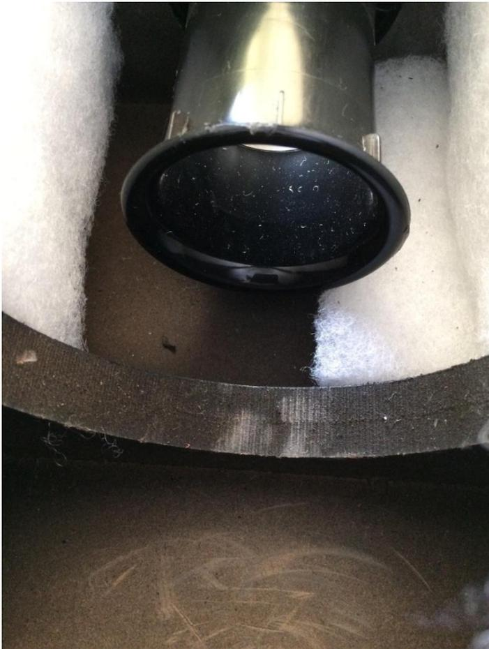
Das MDF-Gehäuse wird mit spezieller Akustikdämmwolle ausgekleidet.
